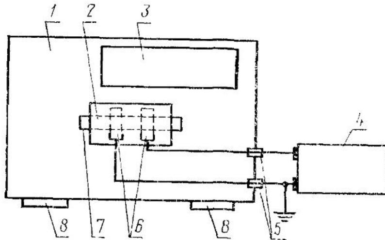
1—гигростатируемая измерительная камера; 2—электродное устройство; 3—устройство для осушки (стабилизации влажности) воздуха; 4—мегомметр; 5—проходные изоляторы; 6—электроды (4 шт.), соединенные попарно (верхний с нижним) гибкими проводами в две группы, подключаемые к мегомметру; 7—образец ленты, помещенный в электродное устройство; 8—окна с укрепленными резиновыми перчатками для выполнения работ в измерительной камере без нарушения ее герметичности
