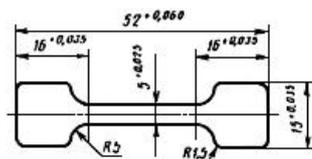
Образцы вырезают в поперечном направлении пленки штампом с шириной рабочей части 5 мм, длиной 20 мм равномерно по длине 1 м пленки.
