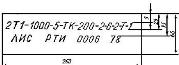
Буквенные и цифровые индексы обозначают ленту № 0006, типа 2, теплостойкую 2Т1 шириной 1000 мм из пяти прокладок ткани ТК-200-2, с обкладками из резины Т-1 толщиной 6 и 2 мм, изготовленную Лисичанским заводом РТИ в 1978 г.
